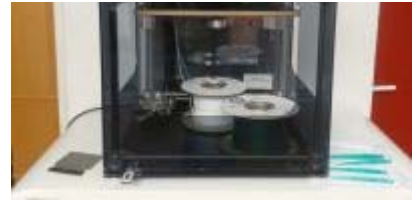
Photo 2 - Imprimante 3D et premières pièces en PLA (en vert en bas à droite)
